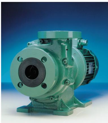
Насосы **VerderMag** представляют собой центробежные насосные агрегаты, оснащенные магнитной муфтой, применение которой позволило передавать крутящий момент от двигателя на рабочее колесо без механического контакта и, как следствие, без традиционного сальникового уплотнения.
