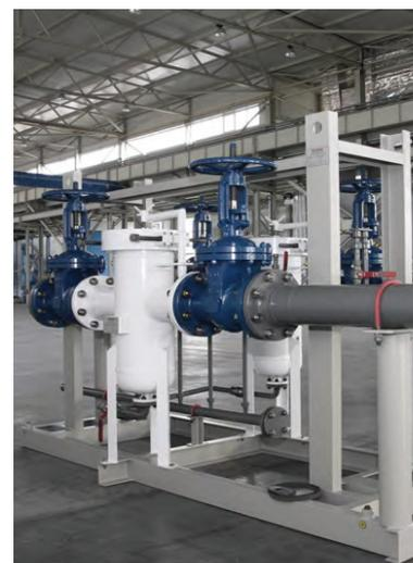
OGSB осуществляет нанесение наружных и внутренних покрытий согласно условиям эксплуатации и нормативным документам, а также в соответствии с требованиями заказчика. Возможно изготовление корзин фильтров, имеющих усиленную конструкцию, обеспечивающую сохранность конструкции при эксплуатации.
